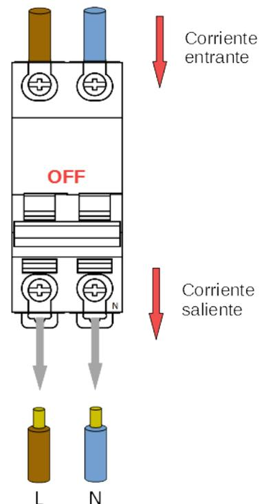
Figura 7 Desconexión de las líneas de corriente
