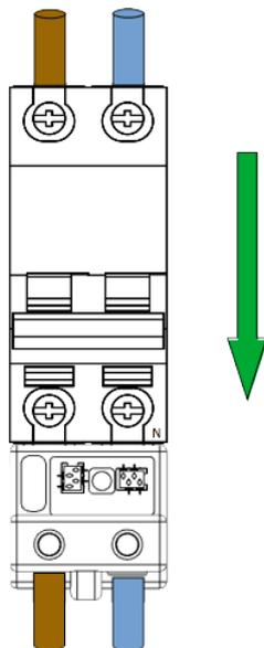
Figura 9 Conexión de CcM2 a interruptor
