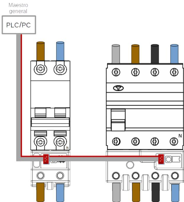
Figura 16 Conexión bus principal CcM2
