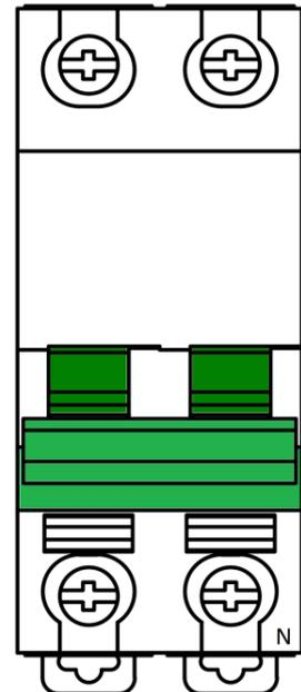
Figura 6 Interruptor magnetotérmico
