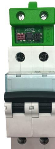
Figura 7 CcM2 instalado en magnetotérmico
